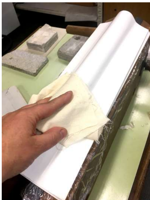
Adhesión y moldeo de las cartulinas.
