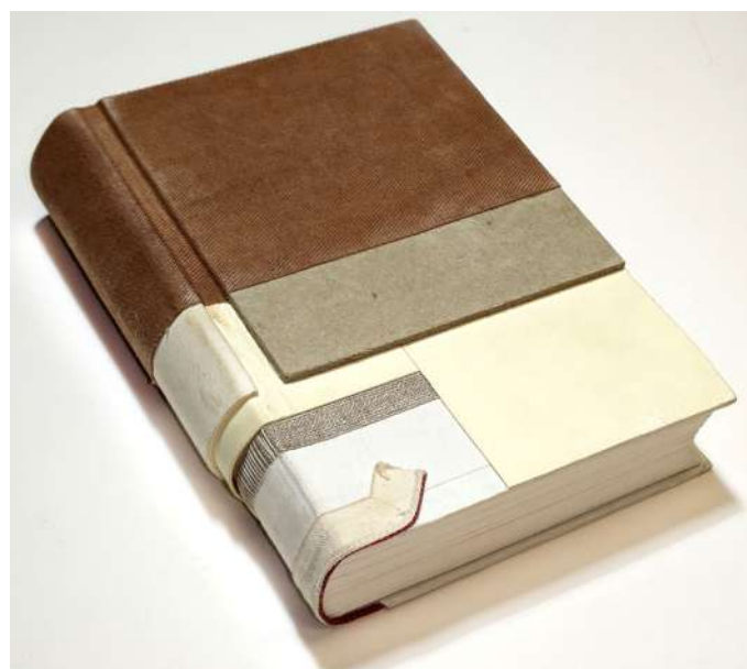
Modelo mostrando los estratos del modelo de lomo-resorte.
