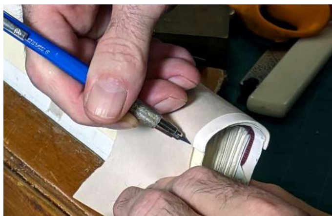
Midiendo el ancho de las capas del lomo resorte sobre la prensa.
