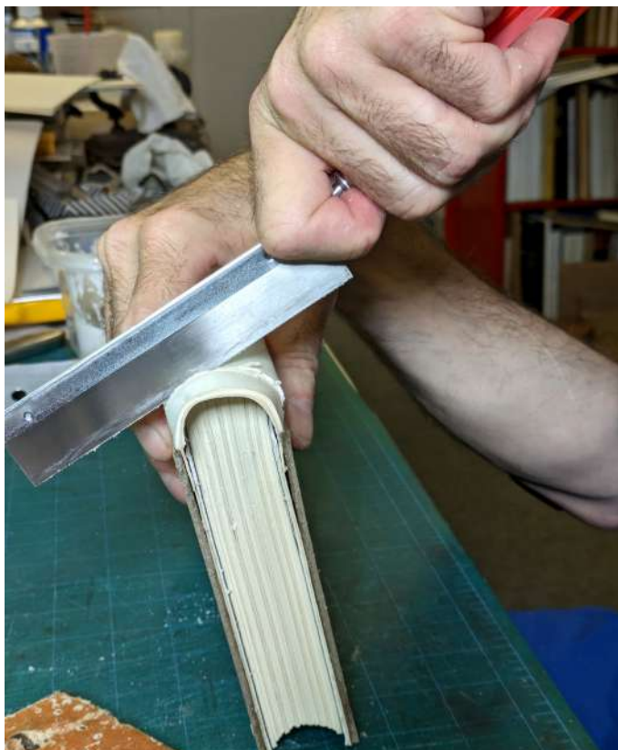
Corte de los extremos del lomo-resorte.
