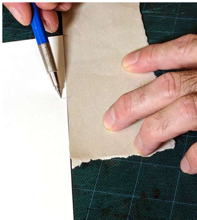
Midiendo el ancho de las capas del lomo resorte sobre la cartulina.
